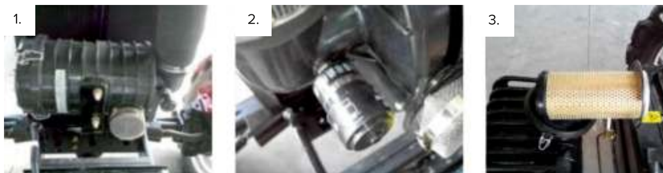
Рис. 22. Обслуживание воздушного фильтра сухого типа.
