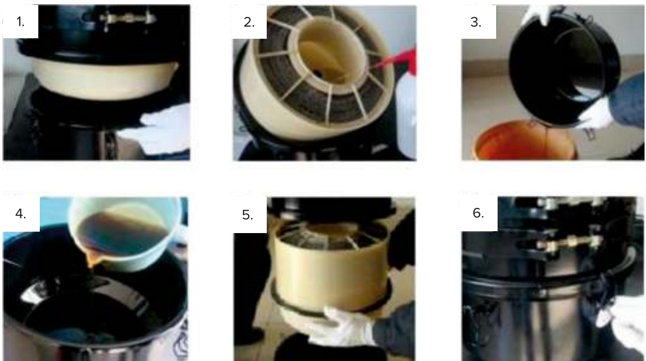
Рис. 21. Этапы обслуживания воздушного фильтра.
